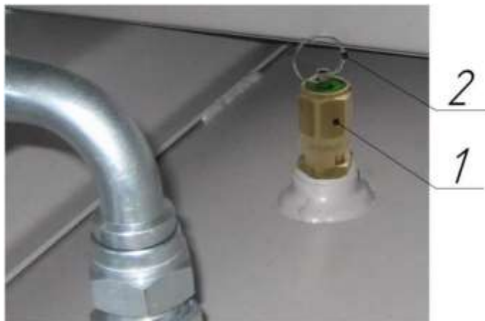
Рисунок 9 – Клапан предохранительный пружинного типа
