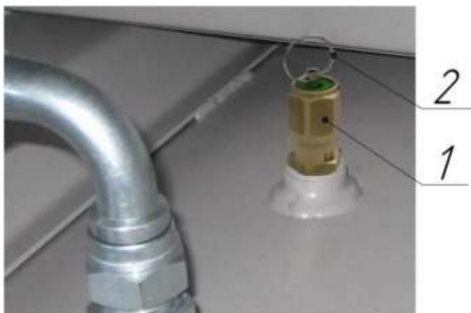
Рисунок 9 – Клапан предохранительный пружинного типа
