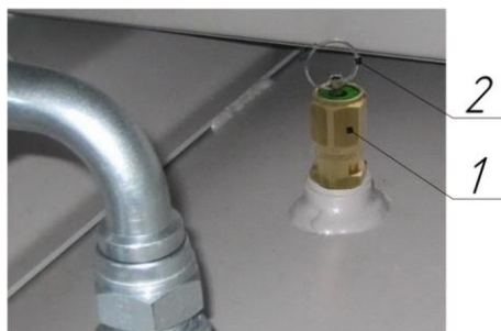
Рисунок 9 – Клапан предохранительный пружинного типа
